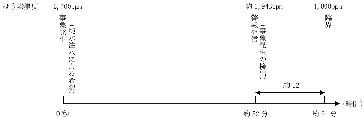
第 1.15-373 図 反応度の誤投入時の臨界到達時間評価結果
