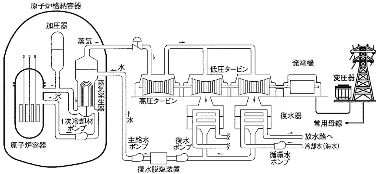
第 1.1-1 図 川内原子力発電所系統概要図
