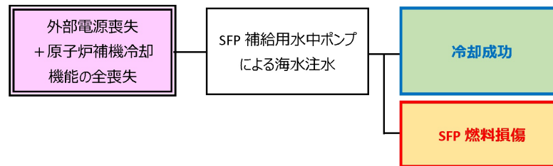
第 3.1.4.5-4 図 落雷評価における評価シナリオ (SFP)
