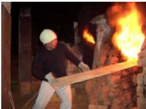
沖縄の窯にはアーチ形の天井側面にカキヤー（ワキグラー）と呼ばれる小さな穴（直径10～15cmくらい）があり、そこから細く短い薪を投入したりする。火が弱い部分を補うための補助穴で、沖縄の登り窯には大体この穴がある。
