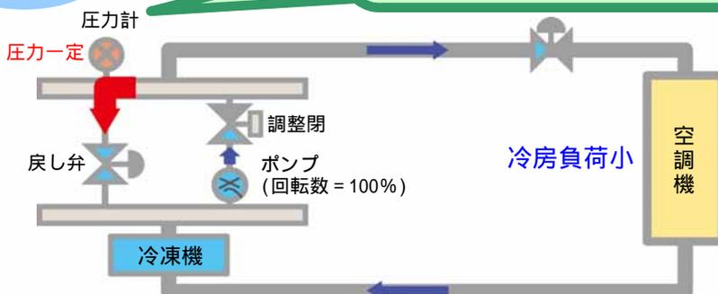
ポンプの吐出圧力及び流量は一定のため、空調負荷が小さい場合は、ポンプ出口のヘッダー圧力を一定に保つように、戻し弁にて水を戻します。
