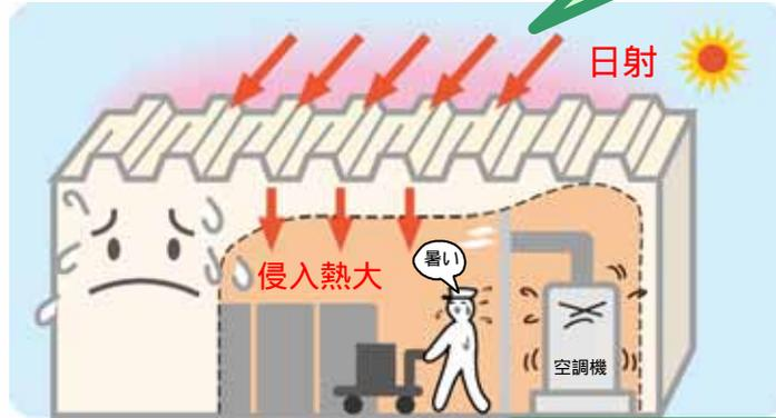
太陽熱による影響を大きく受け、室内温度上昇により空調機の仕事大
