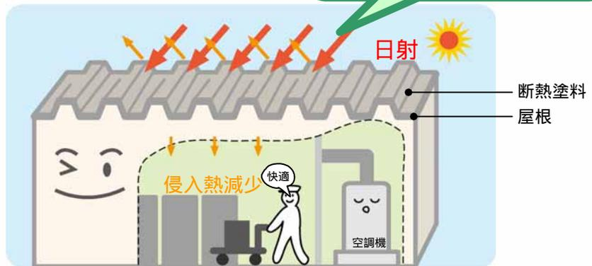
断熱塗料を塗ることにより太陽熱を遮断し、空調機の仕事を削減
