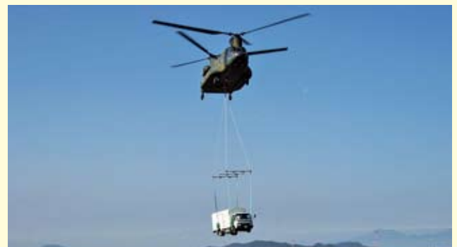
自衛隊のヘリコプターに吊り上げられた高圧発電機車
