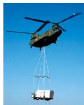
自衛隊のヘリコプターに吊り上げられた高圧発電機車
