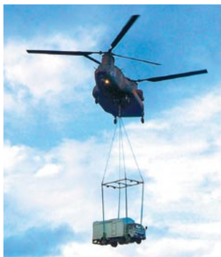
奄美豪雨災害における高圧発電機車空輸
