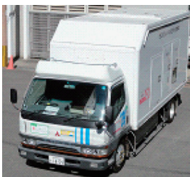
高圧発電機車
