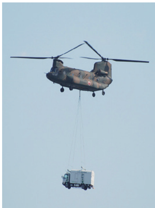
宮崎県総合防災訓練における高圧発電機車空輸
