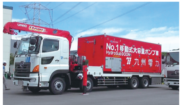
▼移動式大容量ポンプ車
