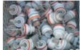
使用済「がいし」 中心の円に取り付けている棒状のものが金属部分
