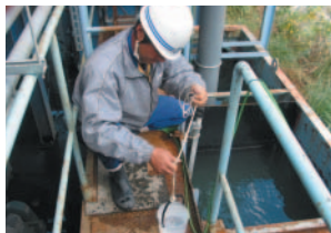
濁水処理設備出口の採水状況
