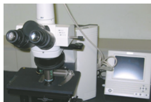
石綿測定装置
