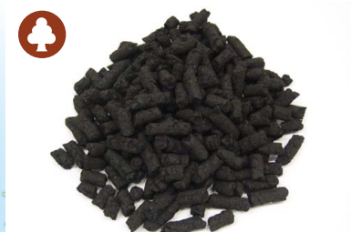
下水污泥固形燃料化事業(松浦発電所)
