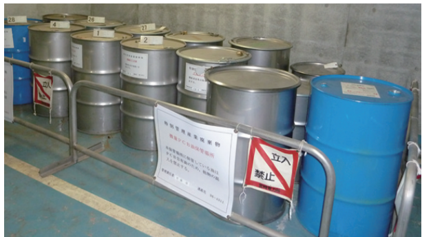
PCB廃棄物の保管・管理状況
