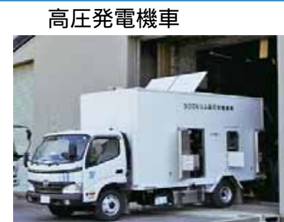
移動式大容量発電機
