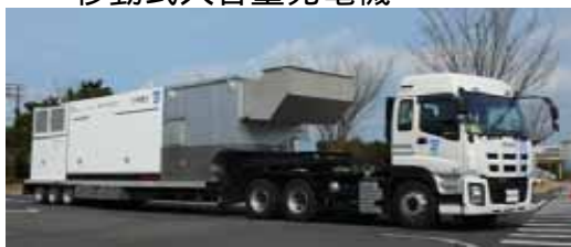
移動式大容量発電機 (設置場所) 海拔 +25.0m (玄海) 海拔 +28.0m (川内)
