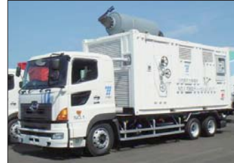
◇可搬型ディーゼル注入ポンプ
