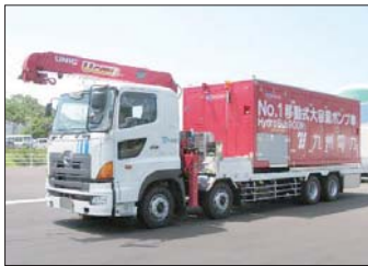
◇移動式大容量ポンプ車
