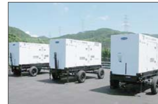
◇直流電源用発電機
