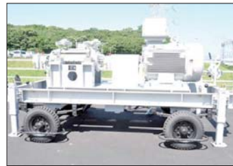
◇可搬型電動低圧注入ポンプ
