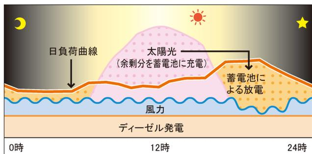
(図4) 太陽光発電の出力変動補償・平準化
