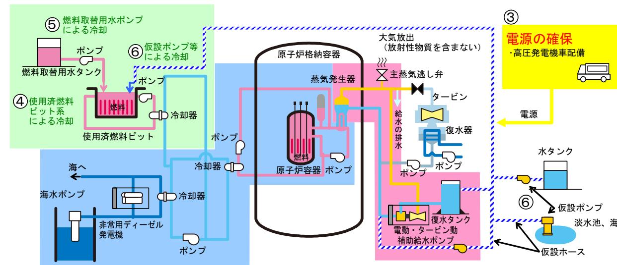
① 海水への熱交換による原子炉の冷却
