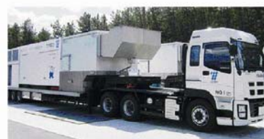
② 移動式大容量発電機
