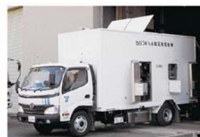
① 高圧発電機車
