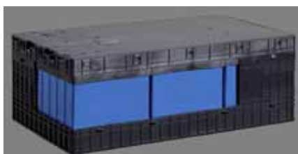
1 モジュール：24 セル(約 1.1kWh)
