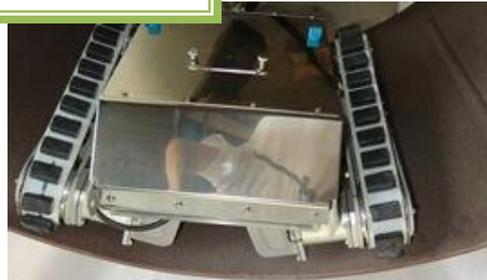
適用管径: 円周方向 <  $\phi$  700、平面管軸方向外面 <  $\phi$  1000、平面管軸方向内面 <  $\phi$  1000、平面 (埋設配管、管内部の検査等)
