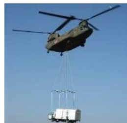
高圧発電機車の空輸訓練
