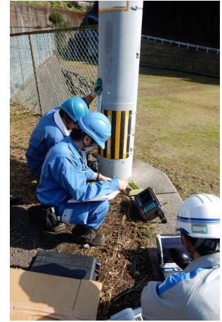
金属柱の超音波点検
