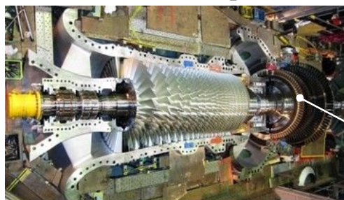
〔LNGコンバインドサイクル発電用ガスタービン〕
