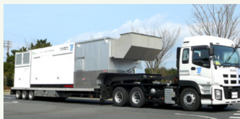
移動式大容量発電機(交流)
