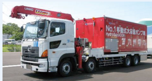
移動式大容量ポンプ車
