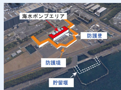
海水ポンプエリアの防水対策
