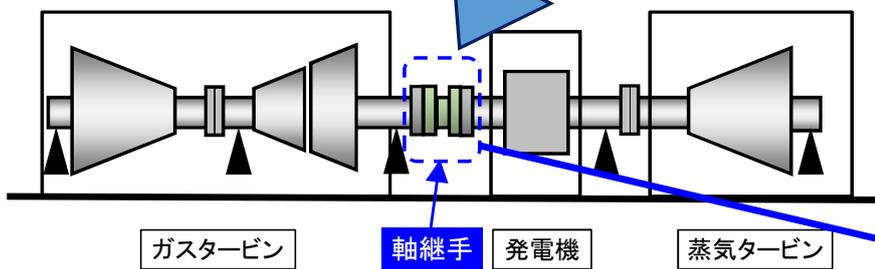
ガスタービンと発電機の軸を接続する軸継手の一部に亀裂を確認
