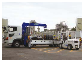
◇電源ケーブルの運搬
