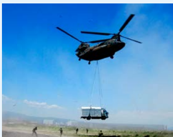
自衛隊との高圧発電機空輸訓練
