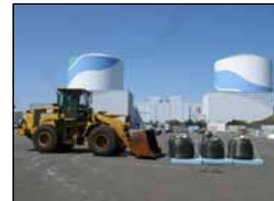
大型ホイールローダによる大きなガレキ撤去
