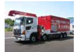
移動式大容量ポンプ車
