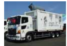
可搬型ディーゼル注入ポンプ
