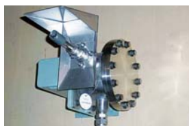
水素燃焼装置
