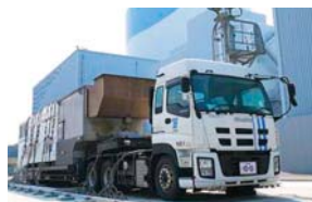
大容量空冷式発電機
