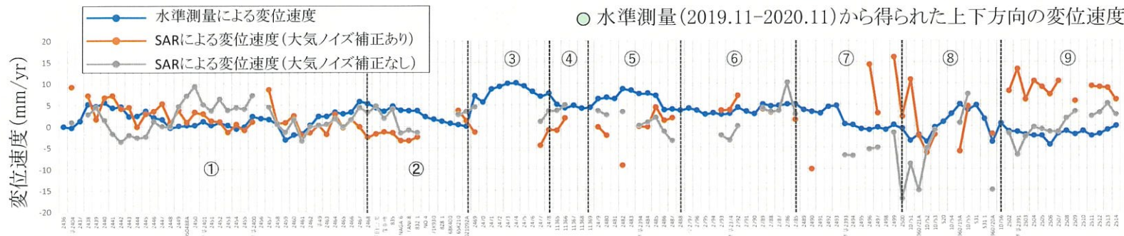
干渉SAR時系列解析と水準測量の比較(左:水準測量結果なし、右:水準測量結果あり)
