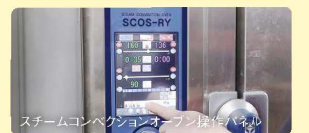
ニュークックチルは温度・時間管理によるマニュアル化がベースとなるため、デジタル制御で数値管理がしやすい電化厨房が選んでいます。
