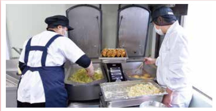
1台で茹でる・焼く・炒める・煮る・揚げるの5役をこなし、2槽式で効率良く調理できるパリオッキングセンター
