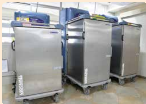
再加熱カート エルゴサーブ (7.75kW×3台) (20膳[10段]×1台、 26膳[13段]×2台)
