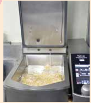
自動給水で給水中は他の作業ができる
