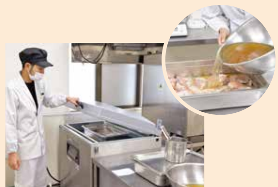
真空包装機による酵素導入(減圧)
