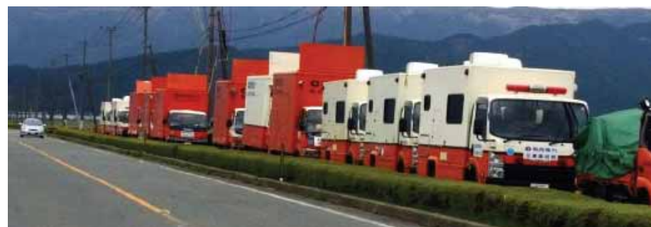
高圧発電機車による送電（関西電力（株））
