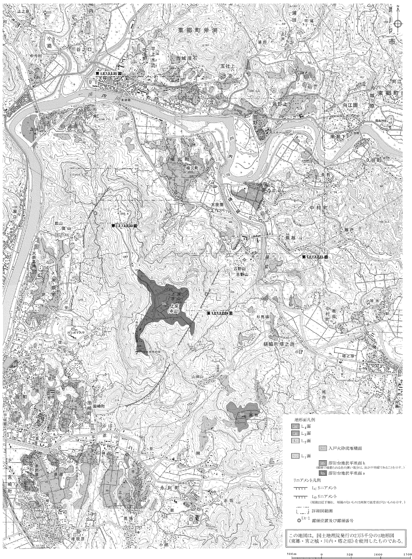
第 1.2.7.3.2.26 図 上床断層及び上床西リニアメント周辺の空中写真判読図
