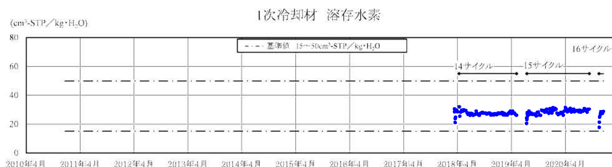
第2.2.1.3-6図 1次冷却材の水質
