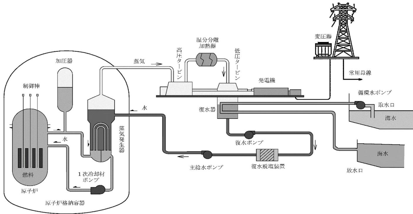
第 1.1-1 図 玄海原子力発電所第 3 号機の系統概要図
