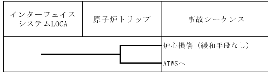
第1.1.1. d-1(d)図 インターフェイスシステムLOCAイベントツリー
