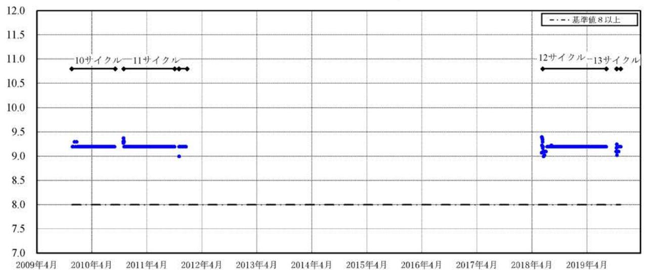
第2.2.1.3-8図 蒸気発生器器内水の水質
