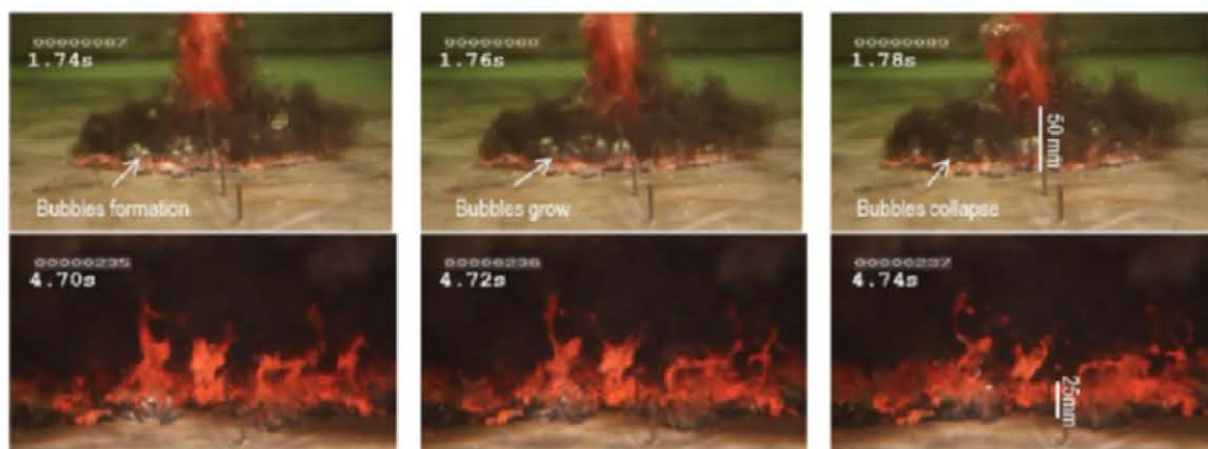
図 3.1-46 PULiMS-E4 試験での溶融物拡がり挙動
