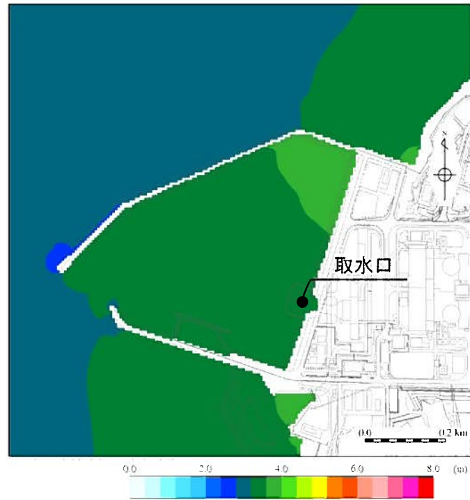
第 3.1.3.4-10 図 基準津波の最大水位上昇量分布(初期潮位: T.P. \pm 0.00\text{m} ) (1/2)
