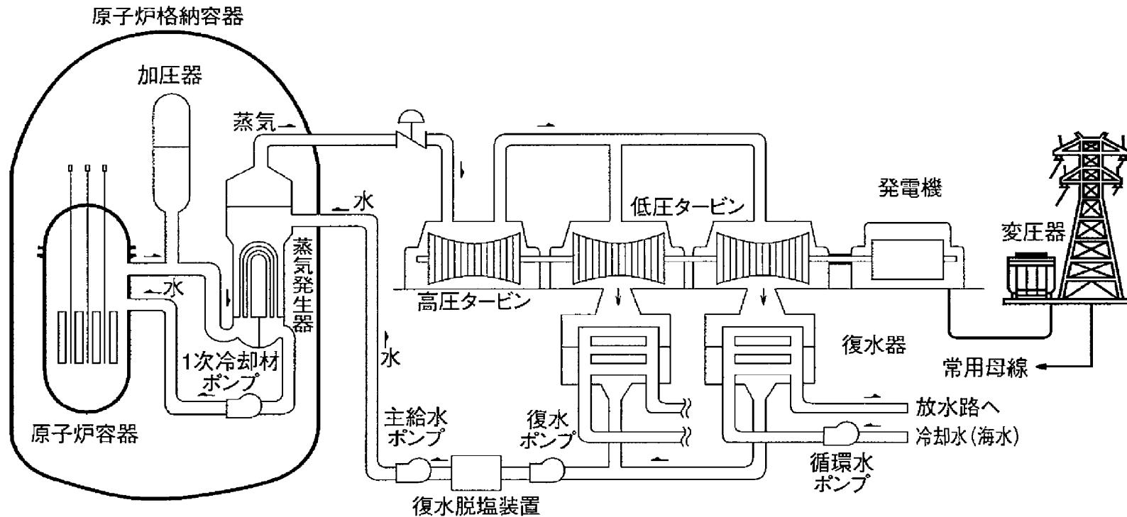
第 1.1-1 図 川内原子力発電所第 1 号機の系統概要図
