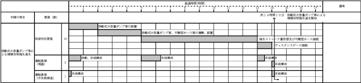
第 1.5.3 図 移動式大容量ポンプ車による補機冷却海水通水 タイムチャート
