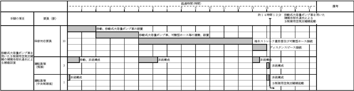
第 1.5.7 図 移動式大容量ポンプ車を用いたB制御用空気圧縮機の補機冷却海水通水による機能回復 タイムチャート
