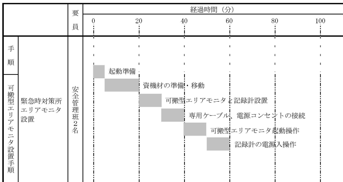
第 1.18.6 図 緊急時対策所エリアモニタ設置
