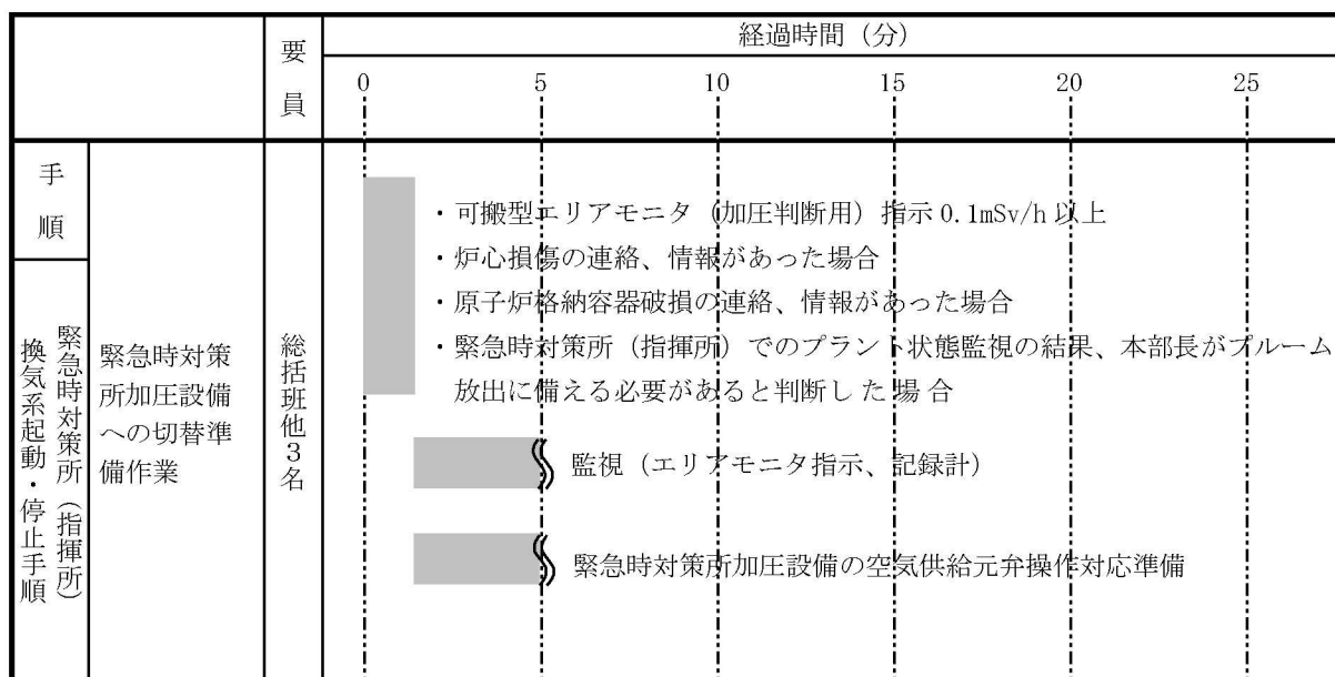
第 1.18.7 図 緊急時対策所非常用空気浄化設備から緊急時対策所加圧設備への切替準備作業 タイムチャート (現計画)
