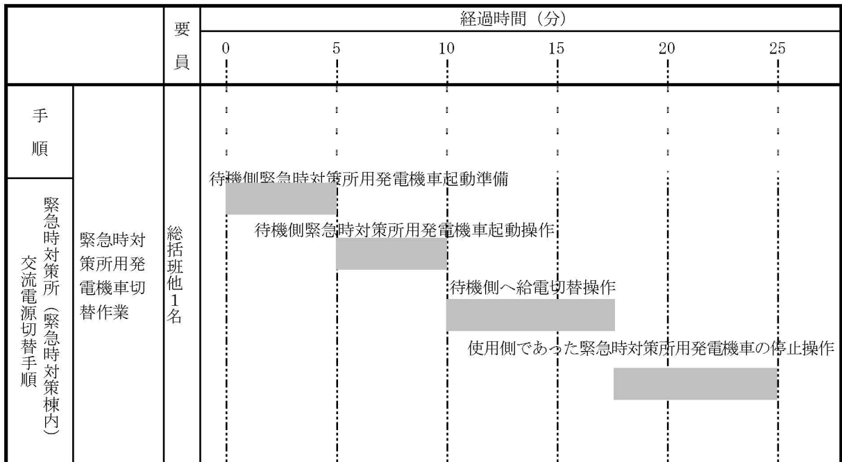
第 1.18.19 図 緊急時対策所用発電機車 切替作業 タイムチャート (現計画)
