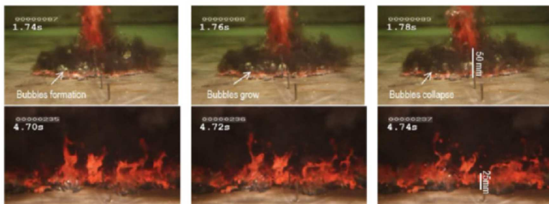
図 3.1-46 PULiMS-E4 試験での溶融物拡がり挙動
